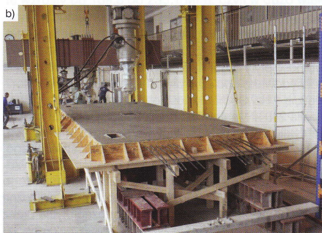
Rys. 4. Układ zbrojenia i sprężenia przed zabetonowaniem (a), płyta po zabetonowaniu (b)
