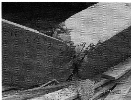
Rys. 3 Widok złamanej belki spoczywającej na ziemi i podporach tymczasowych (a), złamany przekrój belki (b).
